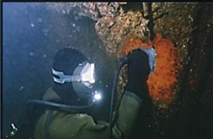
矢板の残存肉厚測定⇒耐用年数算定
