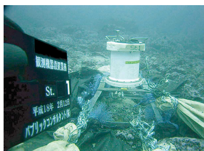
波浪流況調査 (超音波式・水圧式波高計)
