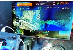
↑ドローンが撮影するデータをリアルタイムで点群化して解析中
