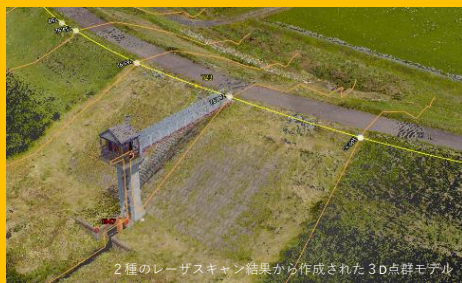
2種のレーザスキャン結果から作成された3D点群モデル
